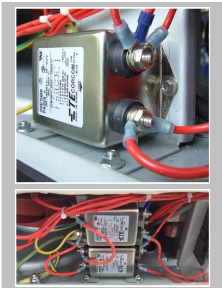
Oben: ein einzelner EMC-Filter (Variante 1.000W e2s) Unten: zwei EMC-Filterkomponenten (Variante 2.000W e2s)
