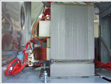
Variante 1.000W e2s: Ein einzelner Hochspannungstransformator speist ein Magnetron.
